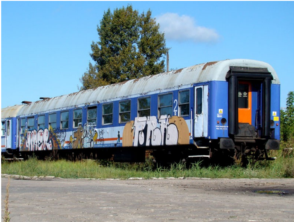
Odstawiony "w krzaki" wagon 110Ab z oznaczeniem serii Bc. Oryginalna powłoka malarska na dachu schodzi płatami, za to na burtach malowanie zostało "odnowione" przez okolicznych pseudoartystów. Wagonownia Warszawa Grochów, 30.08.2009r. Photo by Piotr Kilanowski.
