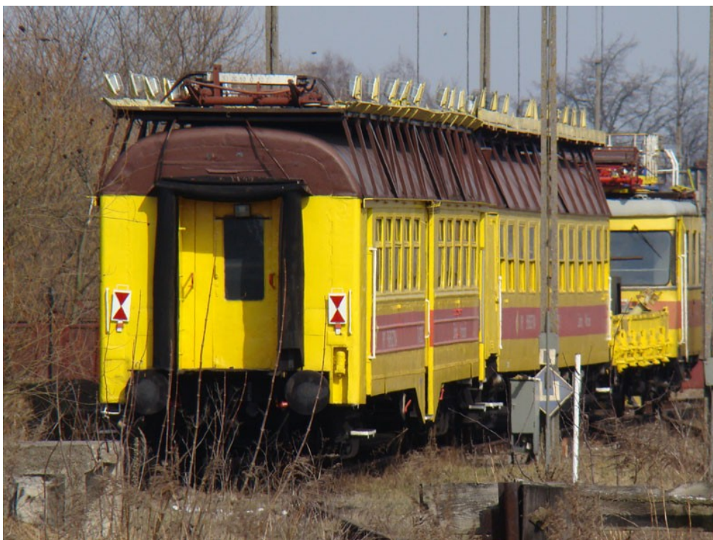
Wagon 43A z przebudowaną ścianą czołową, wchodzący w skład pociągu sieciowego spółki PKP Energetyka. Stacja Ostrołęka, 25.03.2010r. Photo by Piotr Kilanowski.
