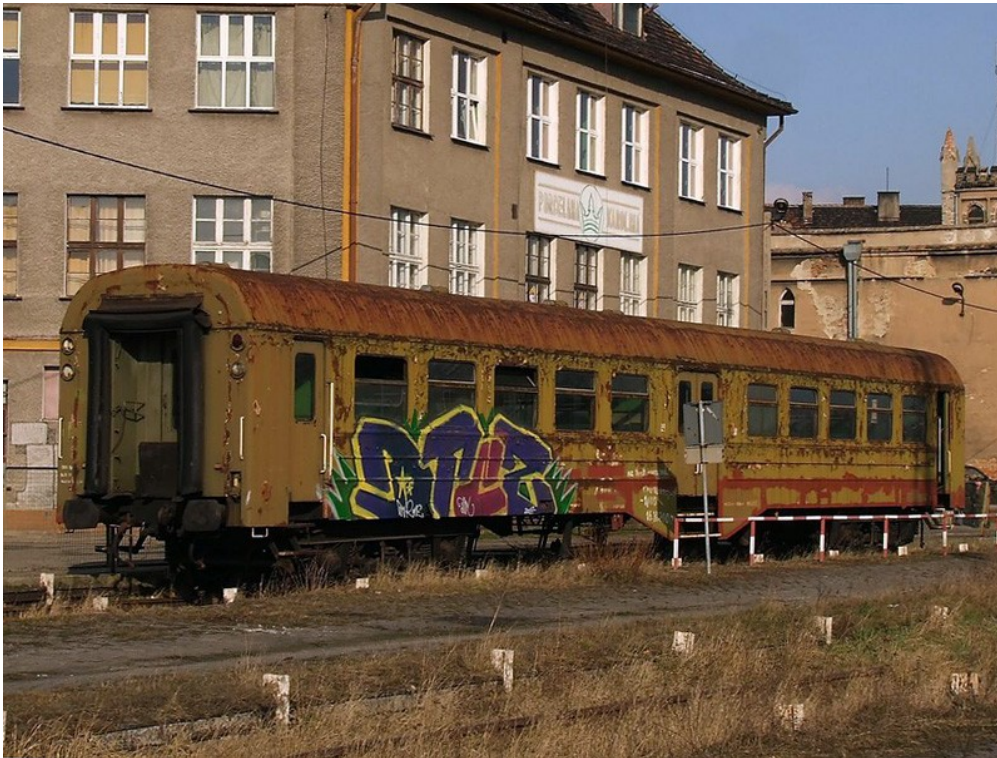
Wagon 43A z przebudowaną ścianą czołową (zaspawana wnęka, dodane gumowe wałki osłonowe) na stacji Jaworzyna Śląska. 4.02.2008 r. Photo by Piotr Kilanowski.
