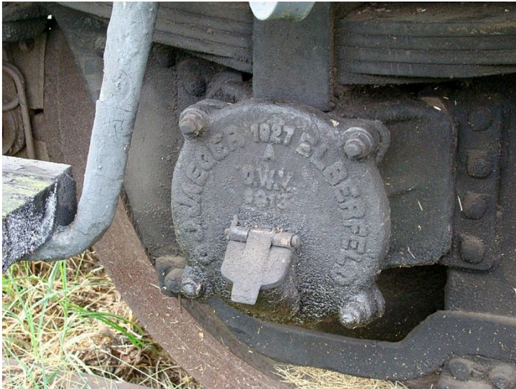
Wagon Dhx Bauart28, zbliżenie na pokrywę maźnicy. Photo by Piotr Kilanowski.
