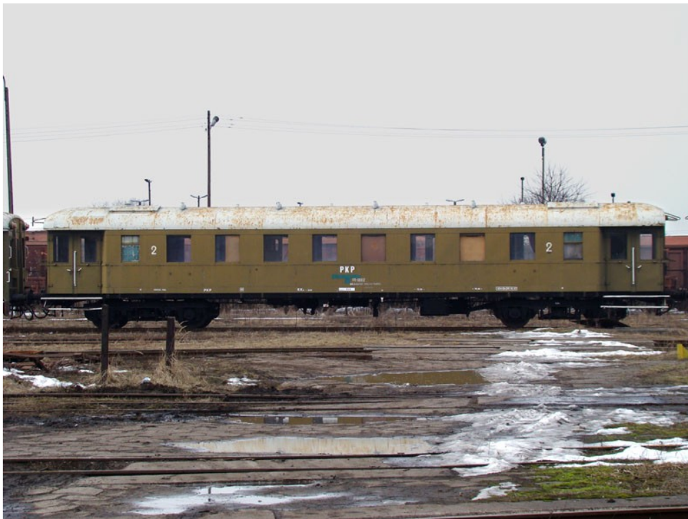
Wagon Bhxz Bauart30 (ex-C4u30) na stacji Białystok, 19.03.2010. Wagon nie posiada oryginalnych wózków, ma wózki typowe dla rodziny 1A. Photo by Piotr Kilanowski.
