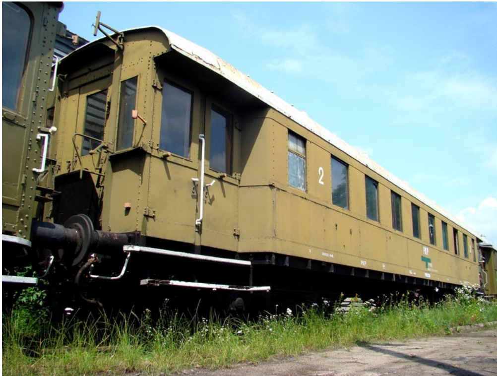
Wagon Bhxz Bauart30 na stacji Białystok, 27.06.2009. Wagon nie posiada oryginalnych wózków Gorlitz II Schwer, ma wózki typowe dla rodziny 1A. Ciekawe, gdzie podziały się oryginalne? Photo by Piotr Kilanowski.
